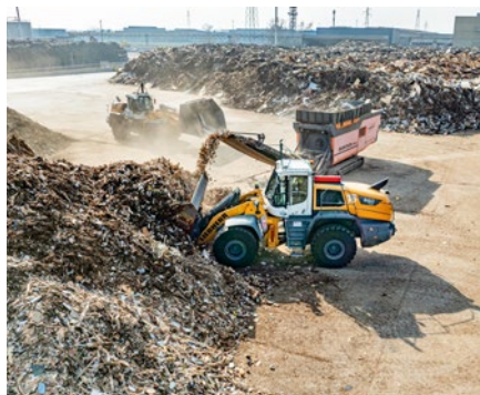
Deux chargeuses sur pneus L 580 XPower alimentent le concasseur.
