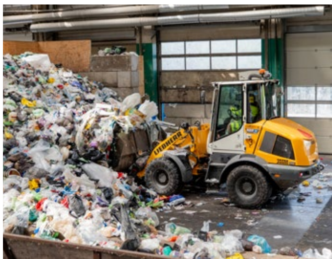
Des chargeuses sur pneus à batterie électrique de Liebherr sont utilisées dans les centres de recyclage à Copenhague.
