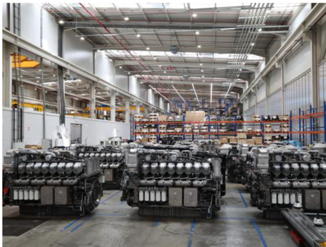
La fin de la ligne de production. Les moteurs attendent d'être testés sur des bancs d'essai. Photo Hervé Kielwasser
