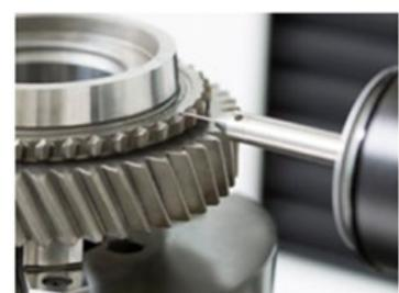
Contrôle d'une entrée de dent
